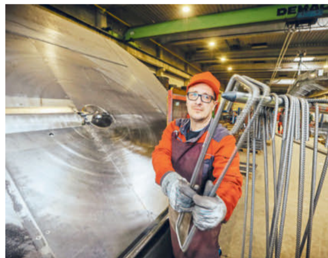
Blick in die bisherige Produktionsstätte: Bremer-Mitarbeiter Nebi Zogaj biegt mit dieser Maschine Baustahl wie Knetgummi.
